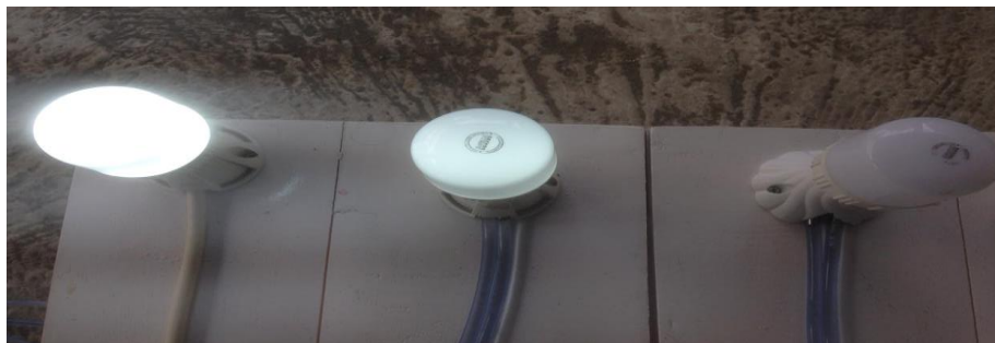
Gambar 5. Nyala lampu 10 Watt dengan urutan (kiri) kabel tembaga, (tengah) kabel larutan garam 400gram dan (kanan) kabel tanpa larutan garam
