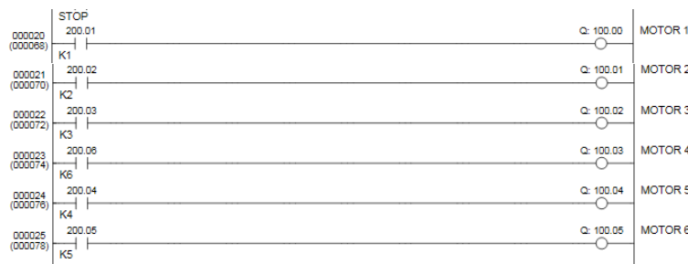
Gambar 7. Diagram ladder persamaan output
