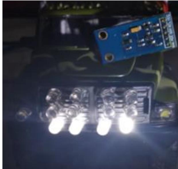
Gambar 8. Tampilan LED Matrix Headlamp pada jarak  $3\text{cm} > X < 20\text{cm}$
