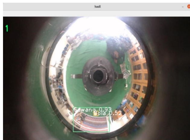
Gambar 10. Pengujian YOLOv3 pada frame 416×416
